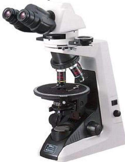
**Рис. 6.2.** Поляризационный микроскоп Nikon Eclipse E200POL
