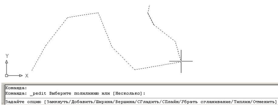
Рис. 4.2. Возможный ввод в командную строку после активации инструмента «Редактировать полилинию» и выбора полилинии на чертеже
